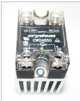
Halbleiterrelais TXSS.002 mit Kühlkörper und Sockel zur Hutschienenmontage 480V/32A
