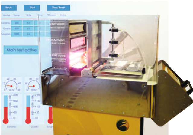
Bild 4. Testvorrichtung zur Bestimmung der besten Wellenlänge für die Infrarotaufheizung (Bild: Friedr. Freek)
