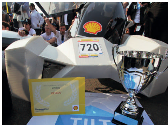
Bild 6. Fahrzeug-Außenhülle aus ligninbestehenden ThermHex-Sandwichplatten (Bild: Burg Giebichenstein Kunsthochschule Halle)
