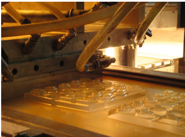
Bild 3. Thermoformen von Maisstärkefolie durch optimierte Aufheizung
