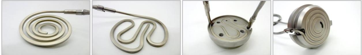
**Beispiel „Stempel“:** D=100 mm aus vergütetem Werkzeugstahl bis max. 700°C Dauertemperatur. Bestückt mit 2 QHP 1500 W/ 230 V, 4,5 x 4,5 mm x 600 mm, davon 50 mm unbeheizt am Anschlusskopf. Biegefähig gegläht mit Ausführung in Nickel bis max. 850°C am Patronenmantel belastbar. Anschluss über glasseidenisolierte Reinnickel-Hochtemperaturlitze (max 500°C) mit Schutzleiter und Edelstahl-Drahtrohrgeflechtschlauch.
