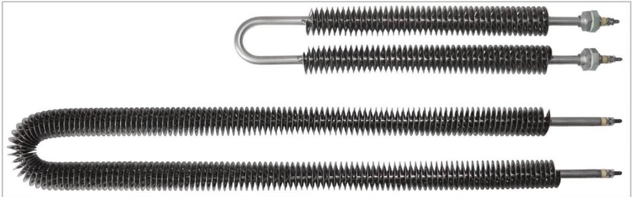
**Rippenrohrheizkörper** sind die ideale Lösung für die Luft- oder Gasstrombeheizung. Die Rippen vergrößern die wärmeabgebende Oberfläche des eingesetzten Rohrheizkörpers um ein Vielfaches.
