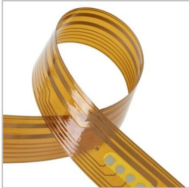
Kapton (Polyamid) ist ein semitransparentes, flexibles und sehr dünnes Isolationsmaterial für Flächenheizelemente. Aufgrund der geringen thermischen Masse, den hervorragenden Isolationseigenschaften und der Beständigkeit gegen die meisten Chemikalien ist das Material für viele Anwendungen geeignet. Es können hohe Oberflächenbelastungen umgesetzt werden. Eine schnelle und effiziente Wärmeübertragung ist damit gewährleistet. Die Temperaturbeständigkeit der Heizelemente liegt bei 200°C.
